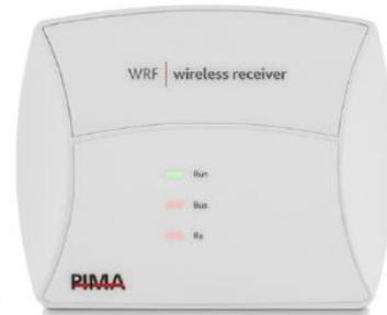
El WRF es un receptor inalámbrico que permite agregar capacidades inalámbricas a los sistemas de alarma contra intrusión de la serie FORCE, y recibir transmisiones de los detectores y periféricos inalámbricos PIMA, convirtiendo en híbridos a estos sistemas de alarma. El WRF se conecta al panel de control a través del bus.
