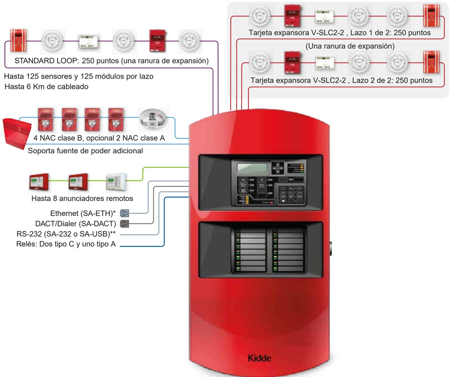
Panel de alarma para detección de incendio, soporta un lazo Clase B o Clase A de hasta 250 dispositivos.
