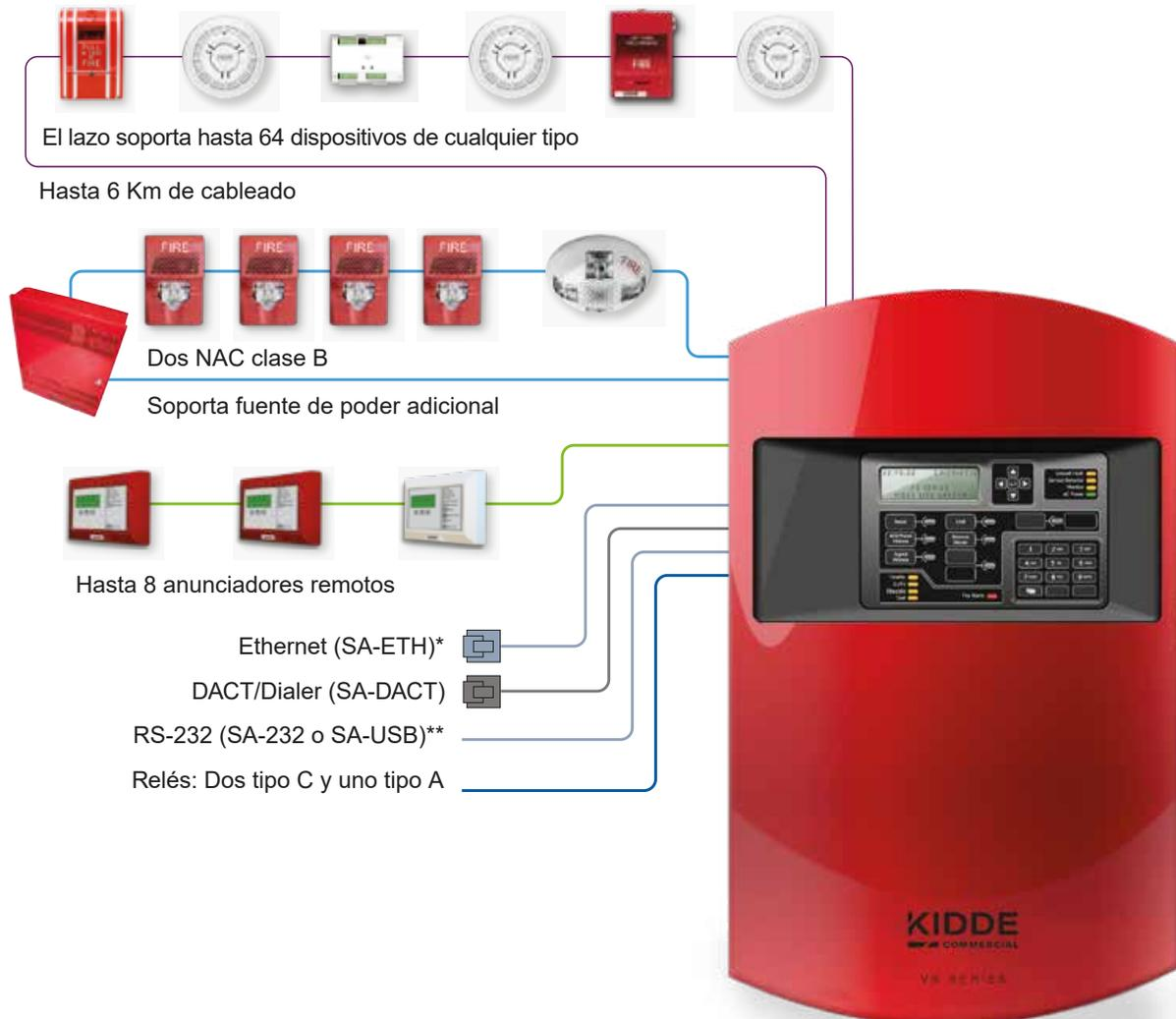
Panel de alarma para detección de incendio, soporta un lazo Clase B o Clase A de hasta 64 dispositivos.
